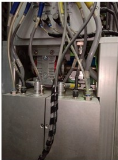
Рисунок 8. Помутнение пластиковой пневмотрубки
