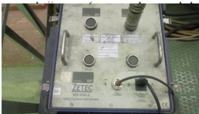
Рисунок 15. Грязь на блоке дефектоскопа.
