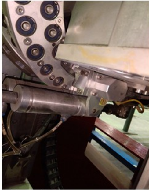
Рисунок 6. Механизм протяжки зонда
