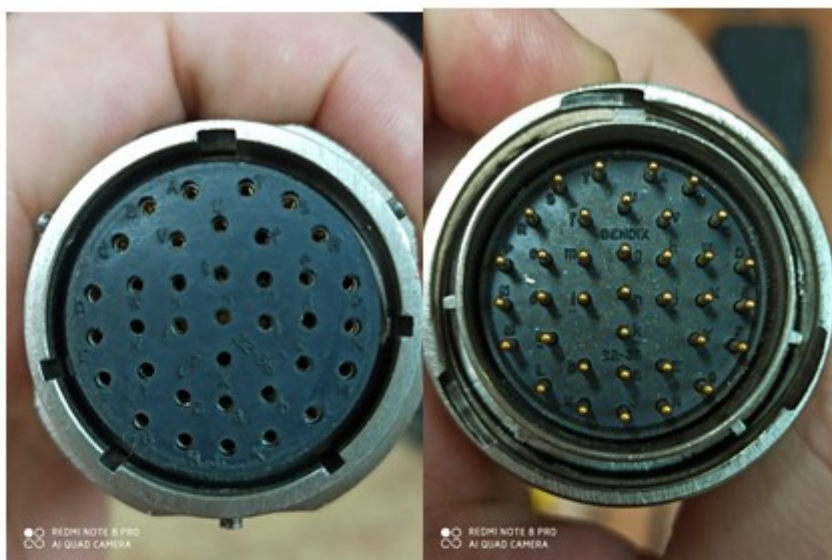
Рисунок 13. Состояние гнезд и штекеров кабельных разъемов.
