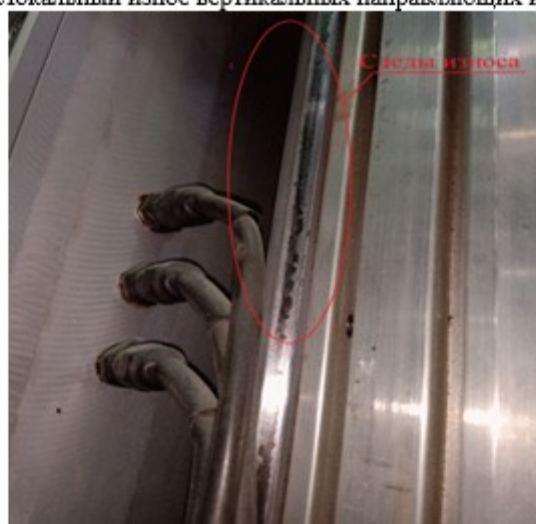
Рисунок 5. Износ вертикальных направляющих и роликов.
