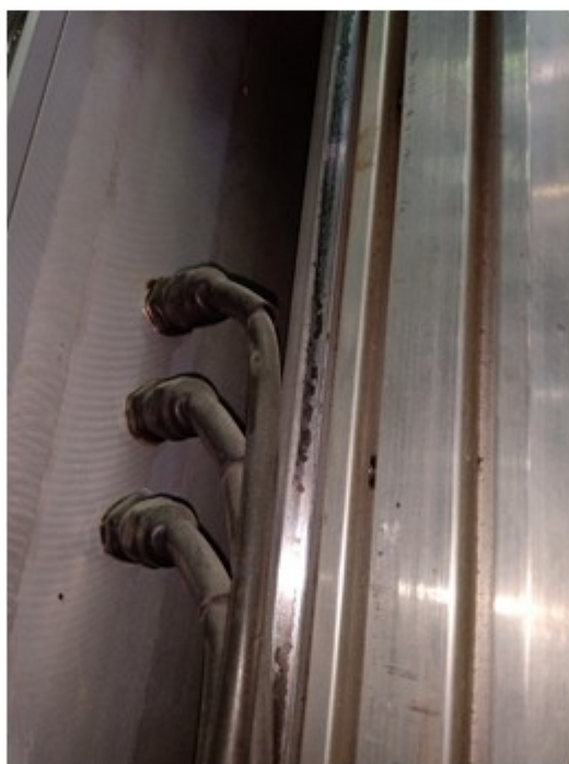
Рисунок 12. На этих трех кабелях держится от смещения весь кабельный жгут пушера №1.
