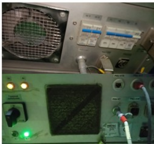
Рисунок 15. Грязь на блоке дефектоскопа.
