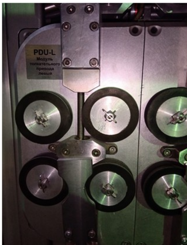
Рисунок 7. Механизм толкательного привода.
