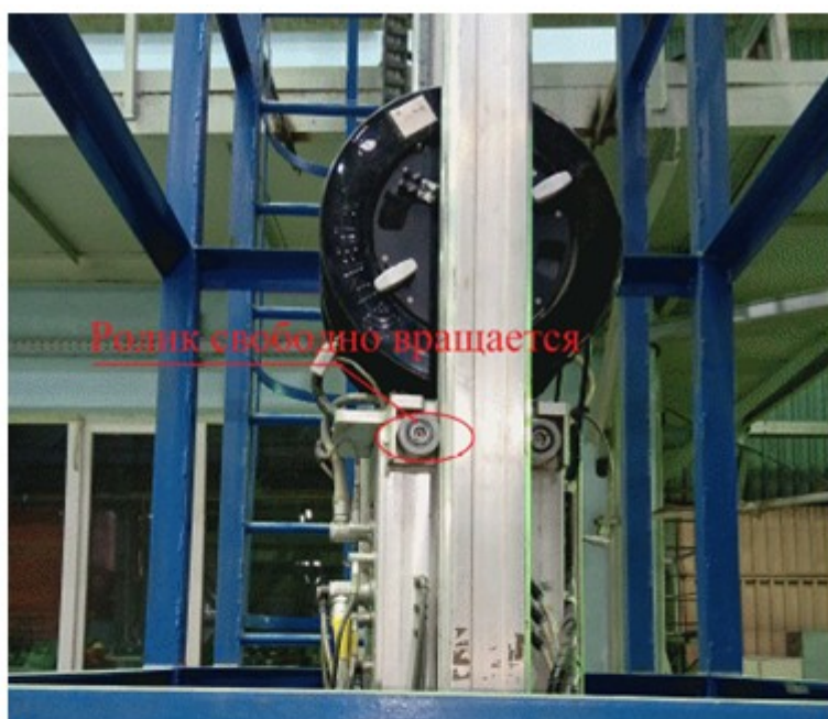
Рисунок 1. Износ вертикальных направляющих.
