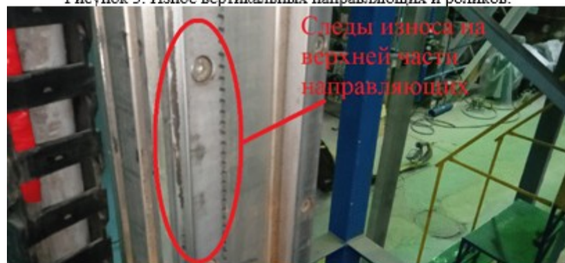
Рисунок 4. Локальный износ вертикальных направляющих и роликов.
