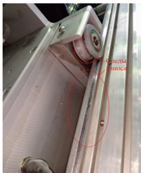
Рисунок 2. Износ вертикальных направляющих и роликов.
