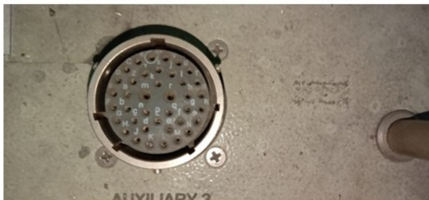
Рисунок 14. Загрязнения гнездовых разъемов.
