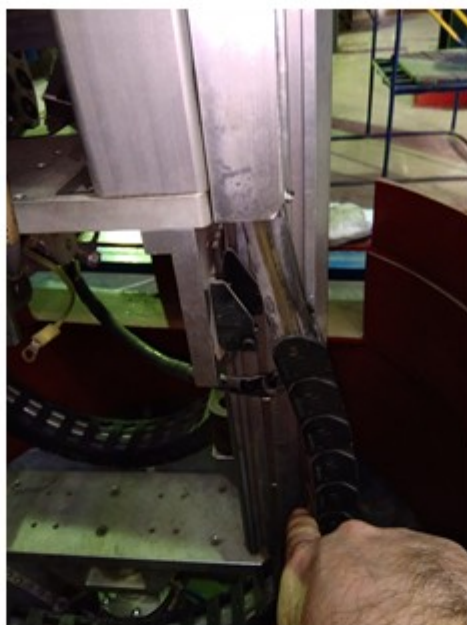
Рисунок 11. Следы механического удара, приведшего к повреждению гибкого кабель-канала.
