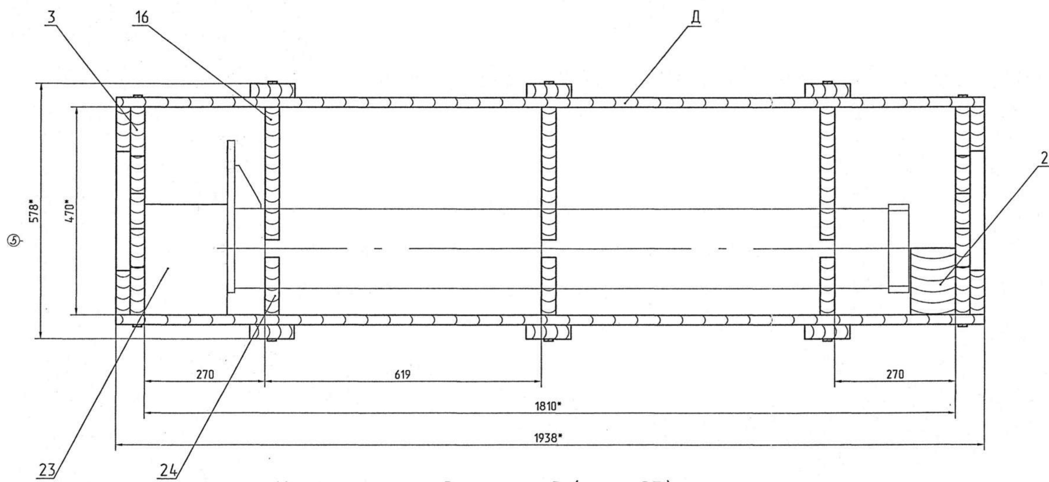
Схема строповки (1:20)
