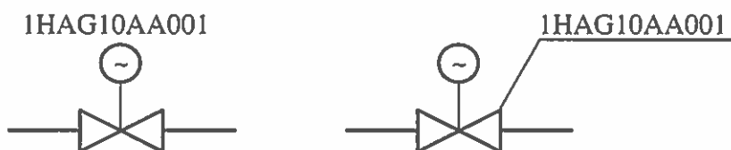
Рисунок 3.6 - Маркировка арматуры в одну строку
