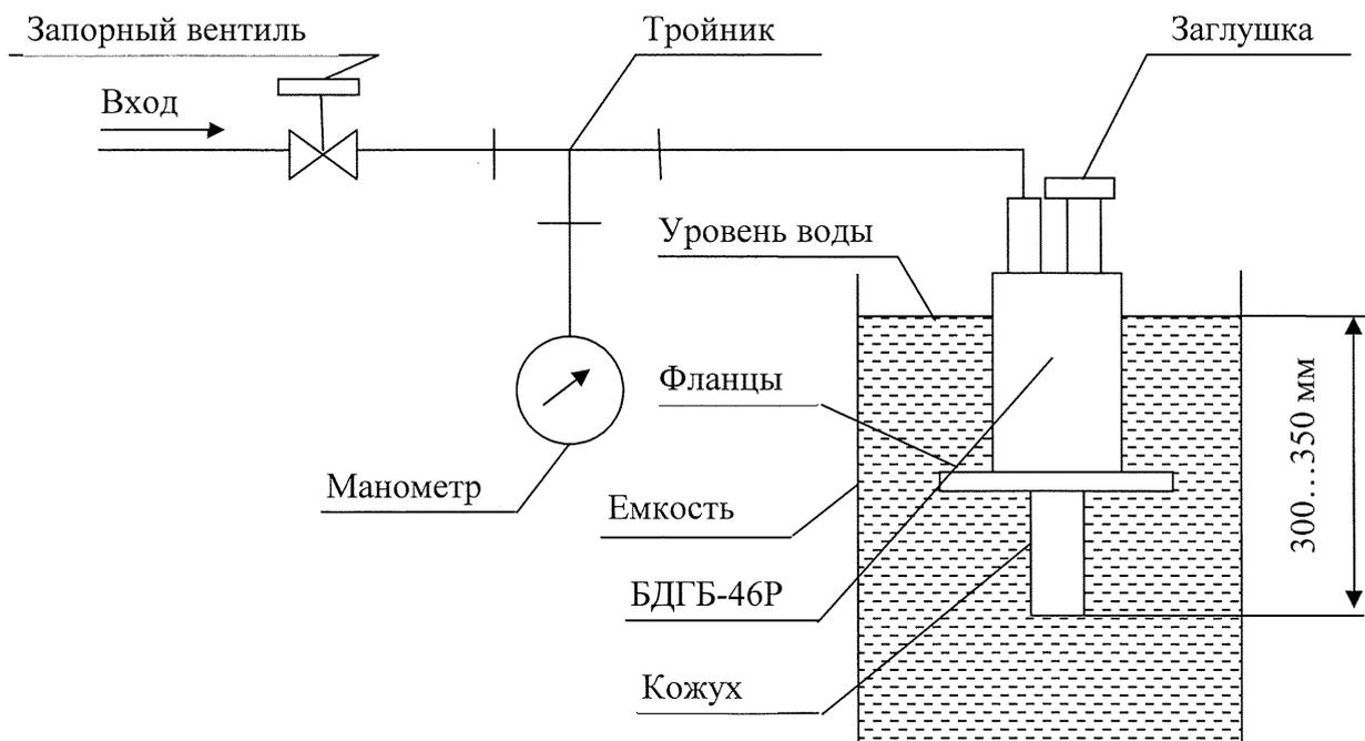
Рисунок - 2 Схема проверки герметичности избыточным давлением
