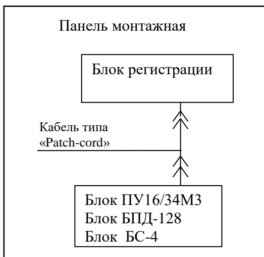
Рисунок 8 Схема монтажа регистратора при местном подключении блоков ПУ16/32М3, блока БПД-128 и блока БС-4
