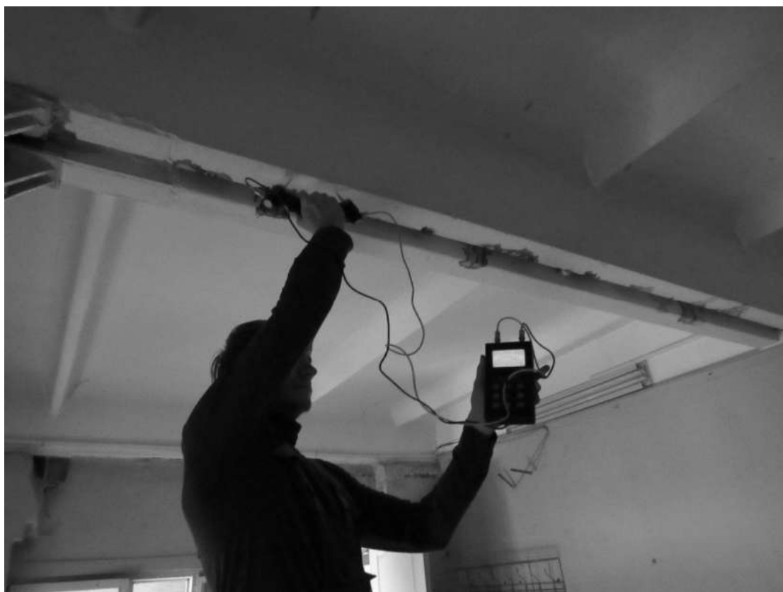
Фото 8. Измерение прочности бетона плит покрытия ультразвуковым методом.
