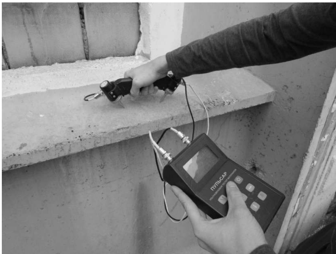
Фото 7. Измерение прочности бетона стеновой панели ультразвуковым методом.
