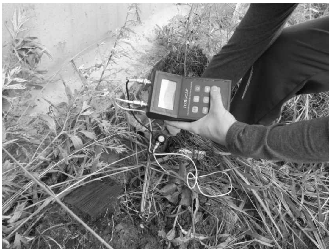
Фото 8. Измерение прочности бетона фундамента ультразвуковым методом.
