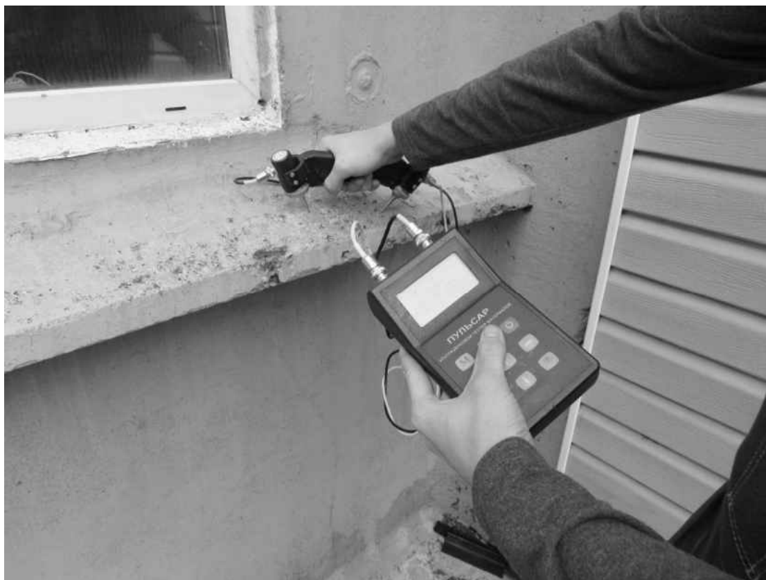
Фото 7. Измерение прочности бетона стеновой панели ультразвуковым методом.
