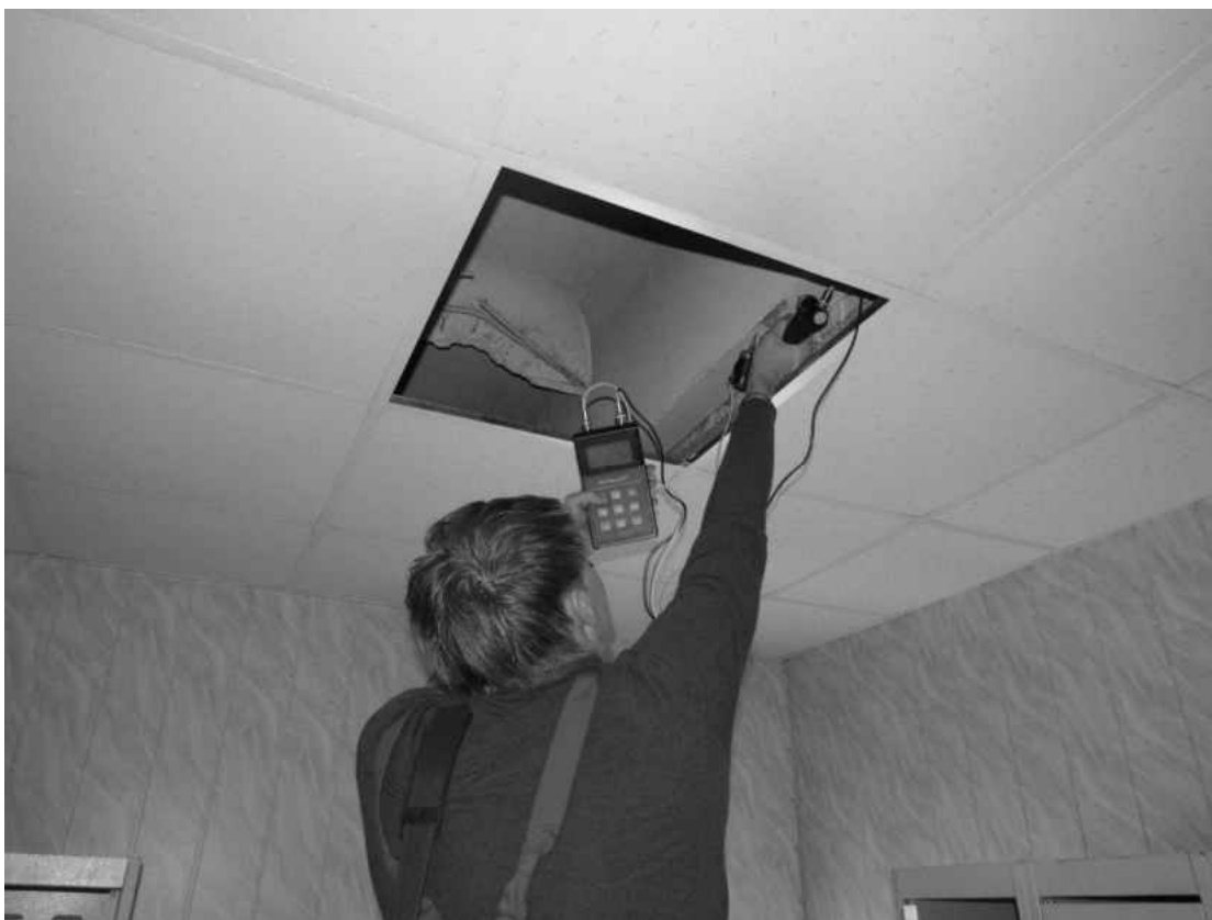
Фото 9. Измерение прочности бетона плит покрытия ультразвуковым методом.
