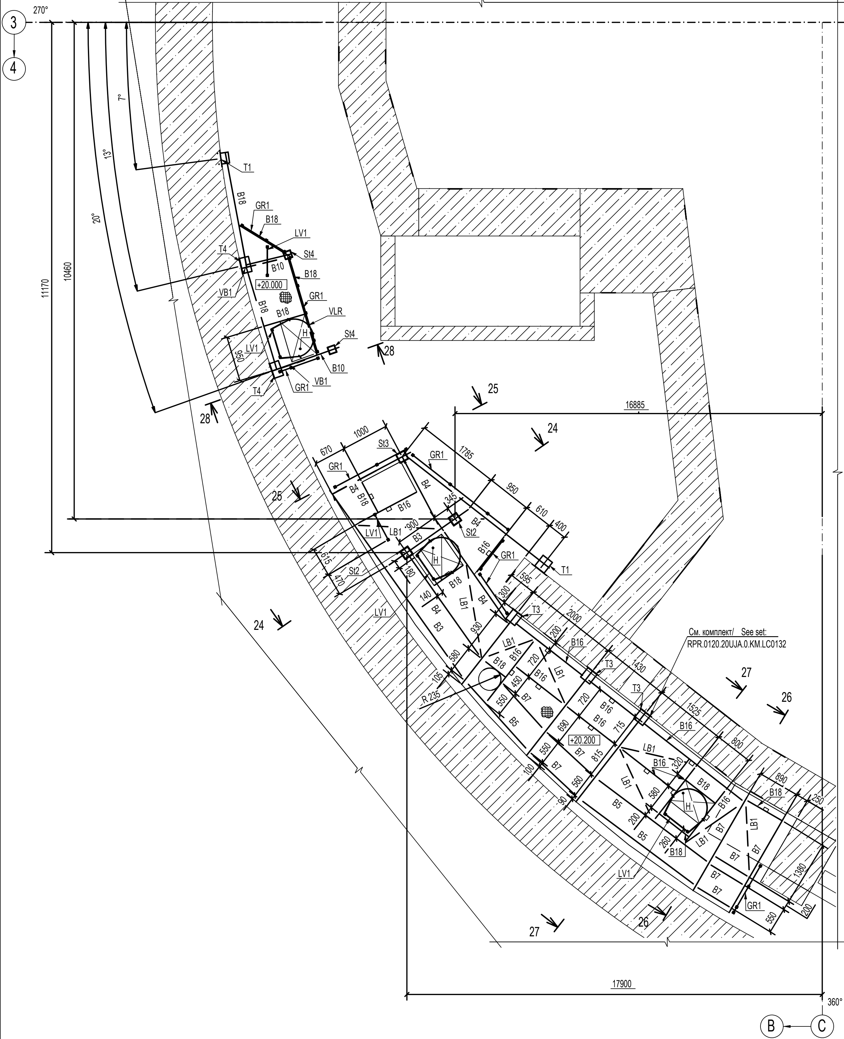
СХЕМА РАСПОЛОЖЕНИЯ ЭЛЕМЕНТОВ ПЛОЩАДКИ НА ОТМ. +20.000 И НА ОТМ.+20.200 В ОСЯХ 270° -360° LAYOUT OF PLATFORM ELEMENTS AT ELEV. +20.000 AND AT ELEV.+20.200 WITHIN GRID LINES 270° - 360°
