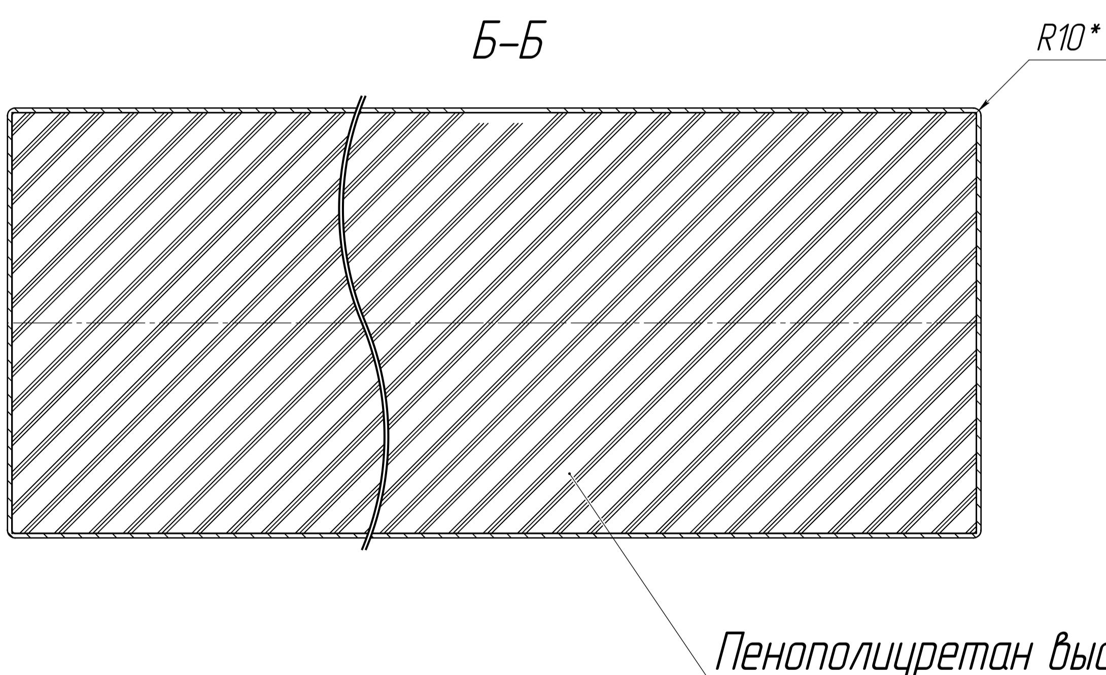
*Пенополиуретан высокой плотности*
