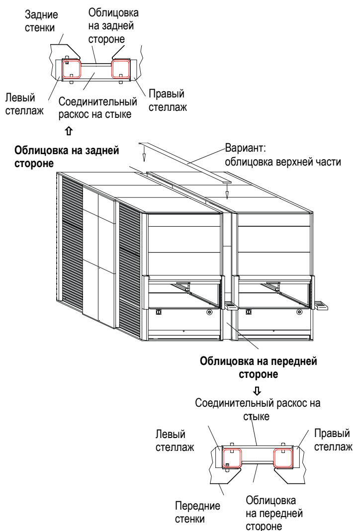
Рис. 57: Монтаж облицовки, в разрезе: трубы прямоугольного сечения/боковые панели соседних лифтовых стеллажей
