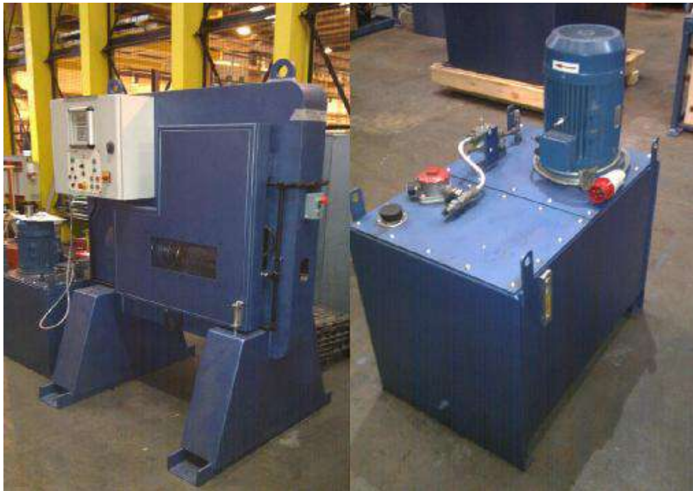
ЧЕРТЕЖ 1: КОВОЧНАЯ МАШИНА ANCON С БЛОКОМ ЭЛЕКТРИЧЕСКОГО НАСОСА
