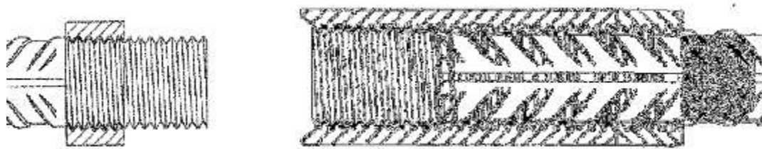
Рис.15. Специализированное соединение Е-СХL-ЕL тип D
