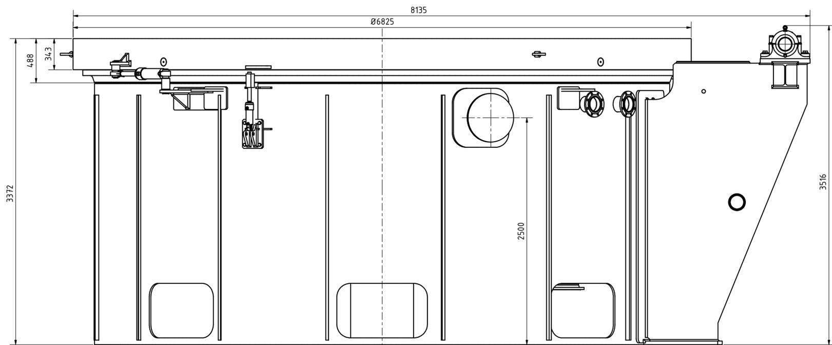
Der Autoklav (komplett mit oder ohne Deckel) wird mit einer 3 - Punkttraverse (für 120t) an den 3 Tragzapfen (je 40t) (beim Anheben auf waagerechte Stellung achten!) angehoben.
