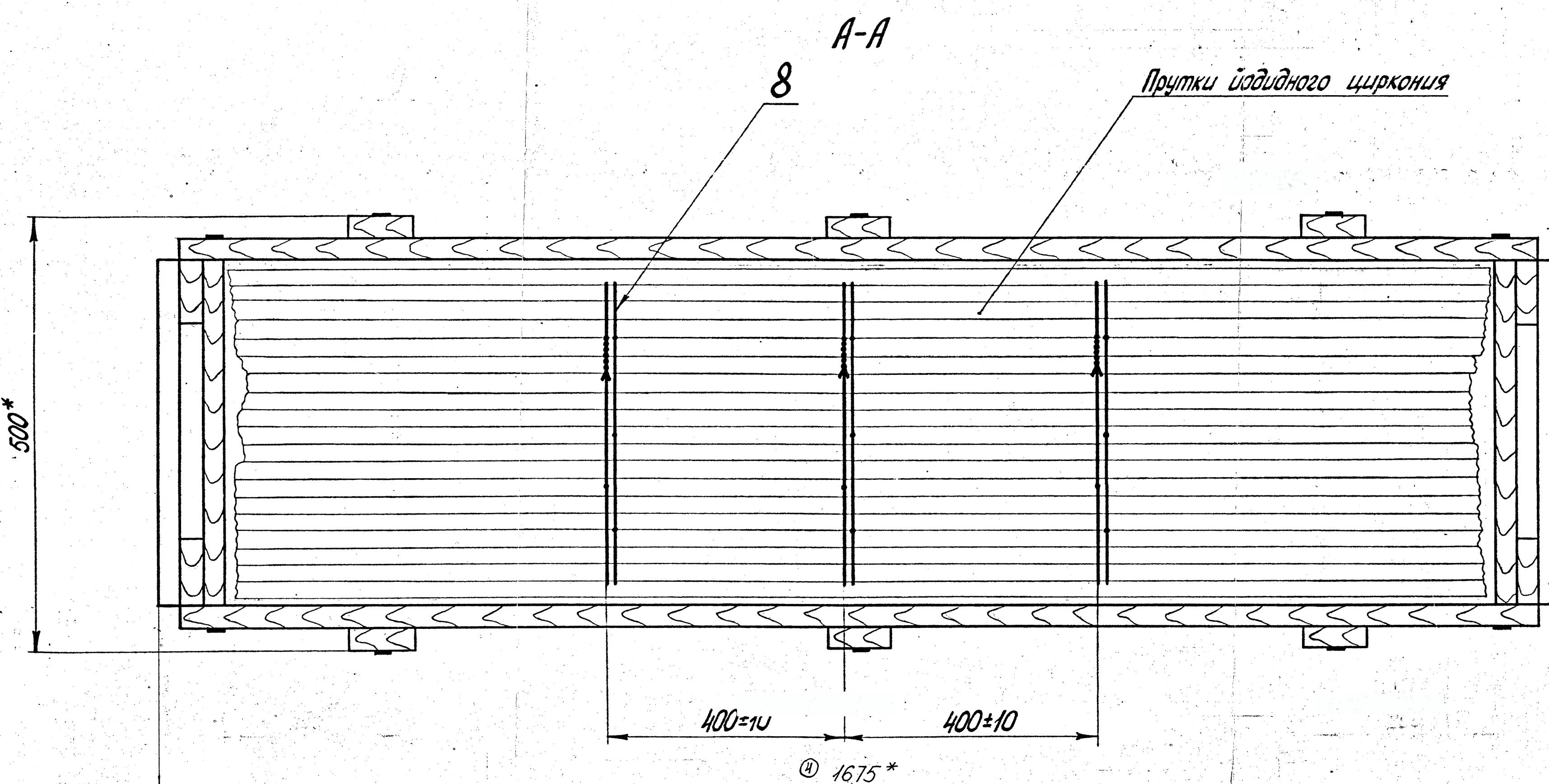
Пакеты прутков должны быть уложены в тару-деревянные ящики. Укладка пакетов прутков должна быть выполнена способом, исключающим их самопроизвольное перемещение внутри тары. Заполнить свободное место в ящике обрезками картона поз. 12, либо обрезками полипропиленовой пленки поз. 9. Допускается укладывать в тару пакеты прутков разных партий.
