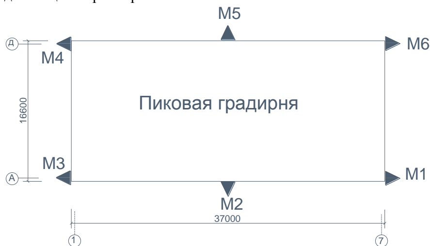
Рисунок Б.10 – Схема расположения осадочных марок на сооружении Пиковой градирни ▲ - существующие осадочные марки
