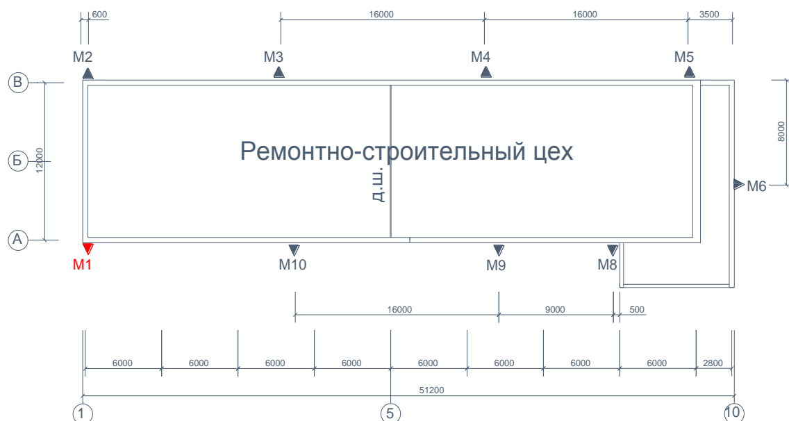
Рисунок Б.19 - Схема расположения осадочных марок на фундаментах здания РСЦ ▲ - существующие осадочные марки, ▲ – дополнительная осадочная марка
