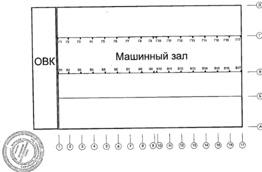
Схема расположения деформационных марок на колоннах машинного зала главного корпуса
