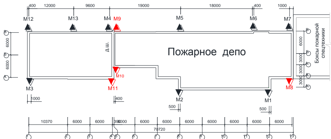
Рисунок Б.14 - Схема расположения осадочных марок на фундаментах здания Пожарного депо
