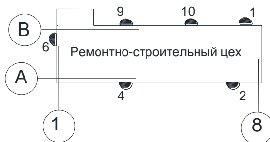
Рисунок Б.18 - Схема расположения осадочных марок на фундаментах здания РСЦ до 1999 (недействующая)
