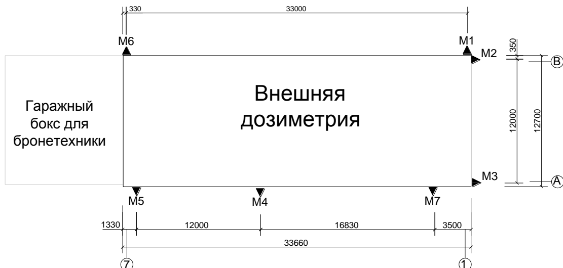
Рисунок Б.17 - Схема расположения осадочных марок на здании Внешней дозиметрии ▲ - существующие осадочные марки
