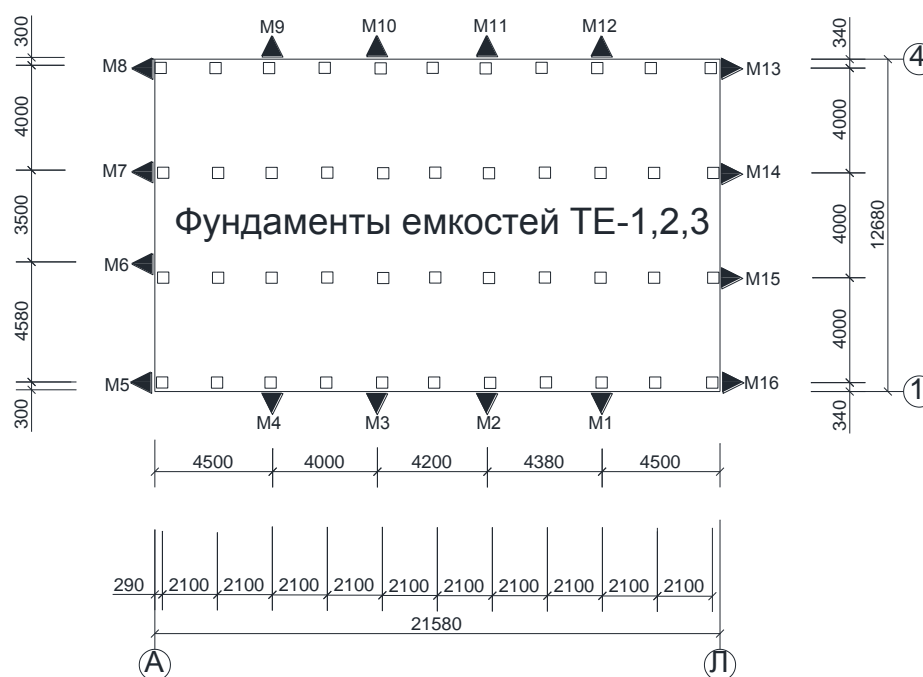
Рисунок Б.28 - Схема расположения осадочных марок на фундаментах емкостей ТЕ-1,2,3 ▲ - существующие осадочные марки
